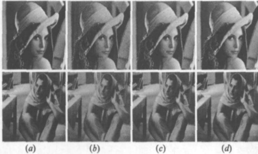
图3 噪声方差为20时的Lena和Barbara的去噪图。(a)原始图像;(b)噪声图像;(c)小波去噪;(d)第二代bandelets去噪;
